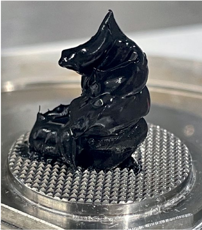
Das gewünschte elektroaktive Polymer soll eine Konsistenz ähnlich einer Handcreme haben, damit die künstlichen Muskeln automatisiert im 3D-Drucker gefertigt werden können.
